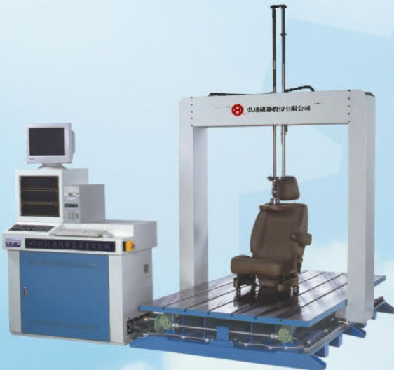
HT-2121A 電腦伺服控制座椅靜態荷重試驗機 Computer Servo Control Seat Static Load Tester
